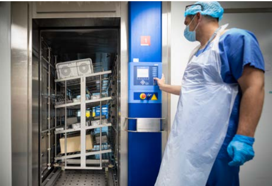
LANCEMENT D'UNE CABINE DE NETTOYAGE POUR LE NETTOYAGE DES ARMOIRES, BACS ET CONTENEURS
