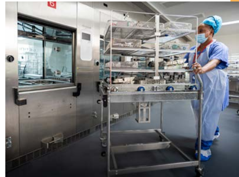
Chargement du module de nettoyage dans un laveur désinfecteur d'instruments
